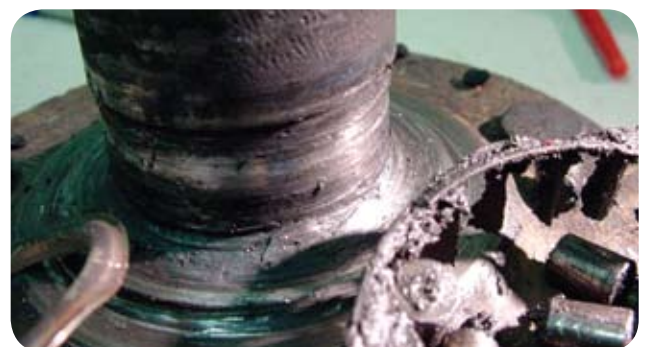
Défaillance du roulement causée par un mauvais ajustement pressé entre la bague intérieure et le moyeu.
