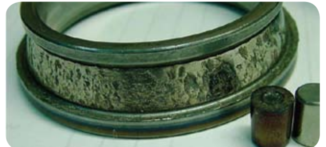
L'écaillage du chemin de roulement s'est produit au bout de 10 minutes d'un essai de 6 heures.
