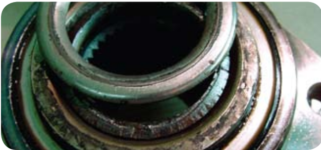
Fracture du moyeu due à un procédé de profilage et de trempage de mauvaise conception.
