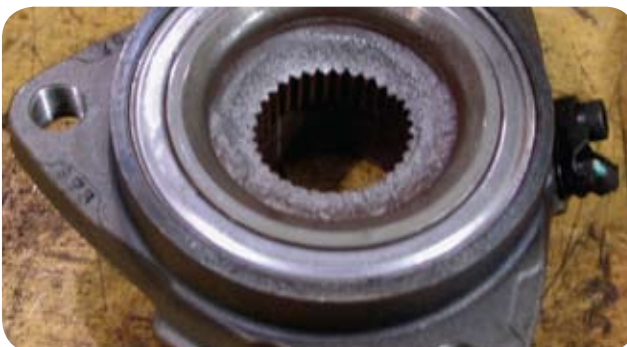
Séparation du moyeu causée par de mauvaises caractéristiques de matériau et une mauvaise plage de dégauchement de roulement.
